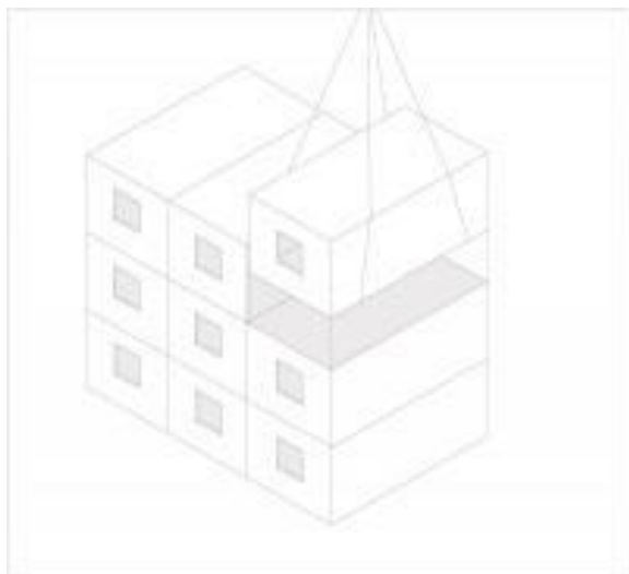
Kuva 3: Periaatekuva tilaelementtijärjestelmällä rakentamisesta
